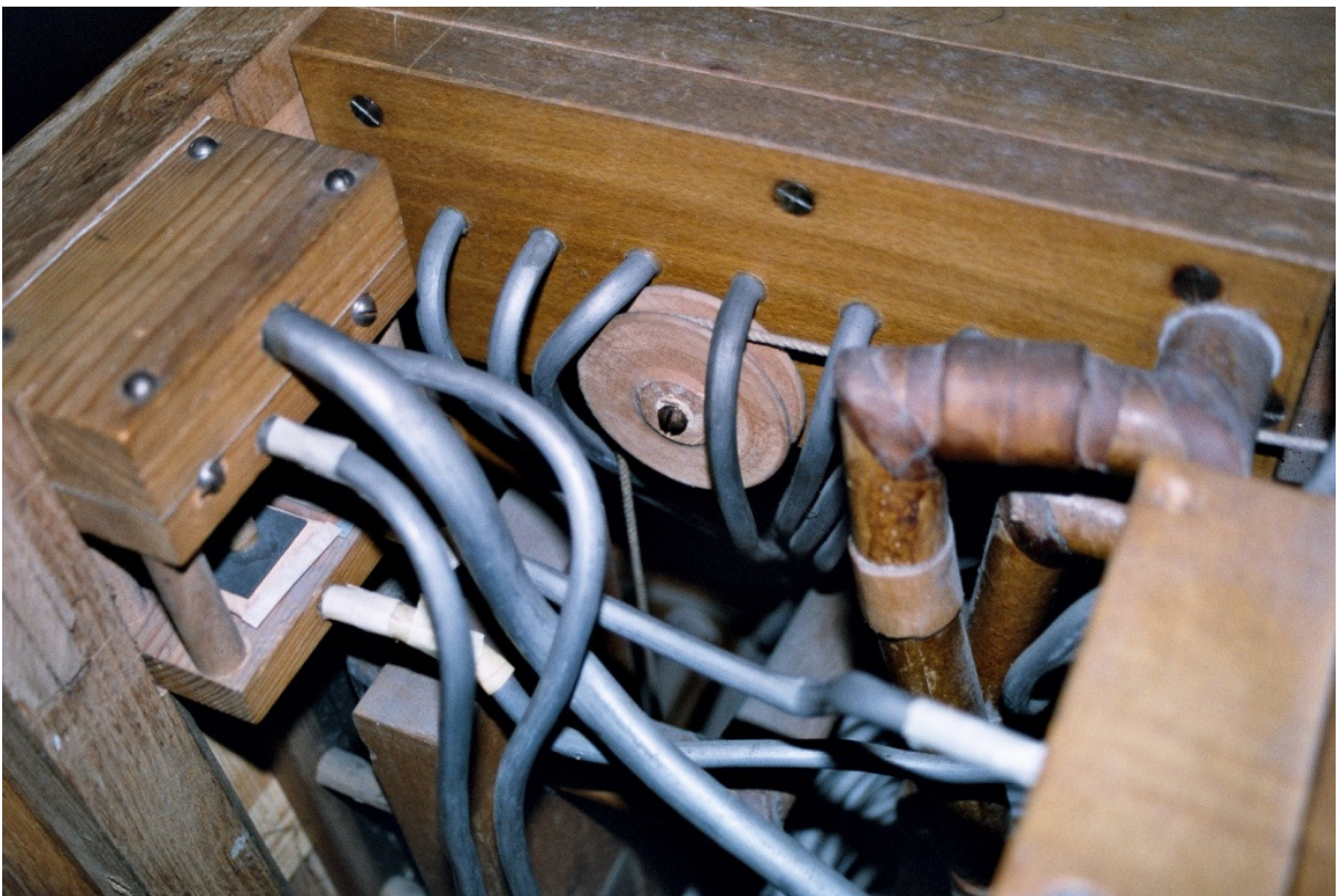
Details am geöffneten Spieltisch; beachtenswert sind die hohen Bleiklotze, welche die Tasten beschweren! (Fotos: Bernhard Hörler 2009)
