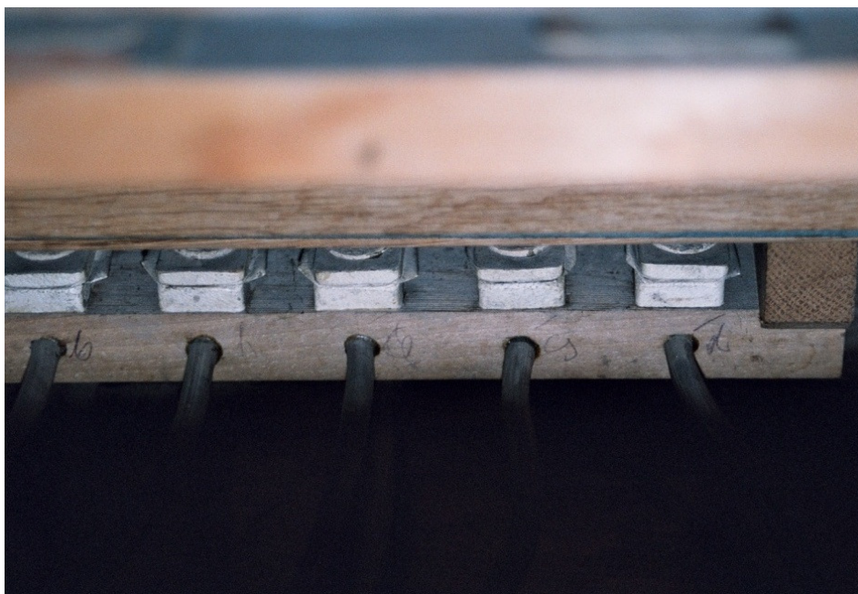
Taschen zum Heben der Kegel der Pedalladen (Foto: Bernhard Hörler 2009)
