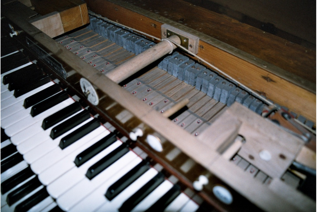
Details am geöffneten Spieltisch; beachtenswert sind die hohen Bleiklotze, welche die Tasten beschweren! (Fotos: Bernhard Hörler 2009)
