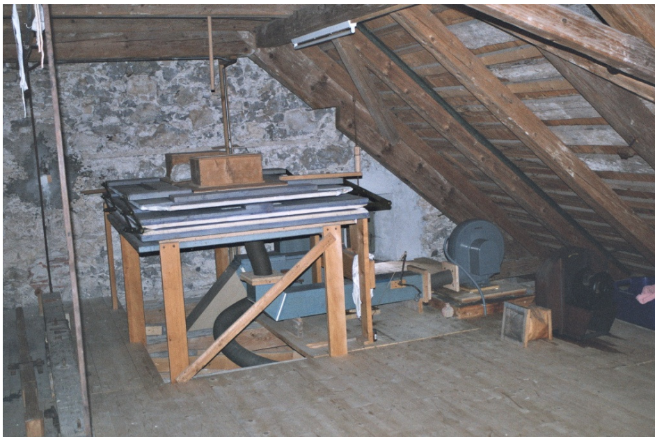
Der frei im Estrich aufgestellte Magazinbalg (Fotos: Bernhard Hörler 2009)
