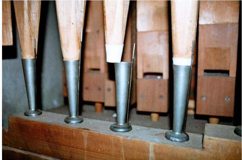
Zusammensetzung der Becher der Posaune 8'
