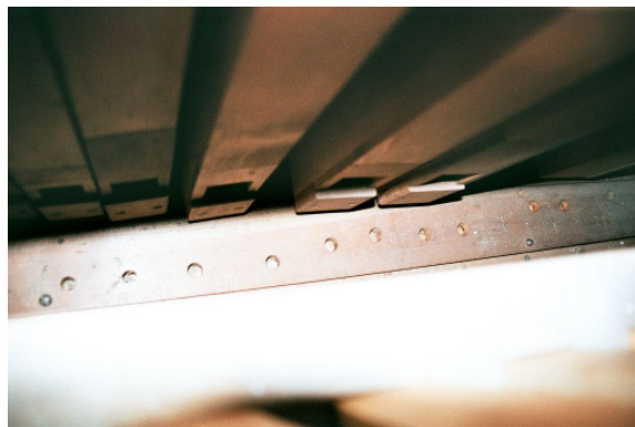
Die Bohrungen für den Violoncellobaß 8', dahinter der Octavbaß 8'
