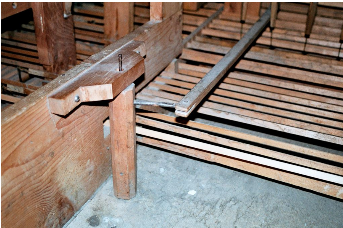
Die Mechanik des Collectivzugs
