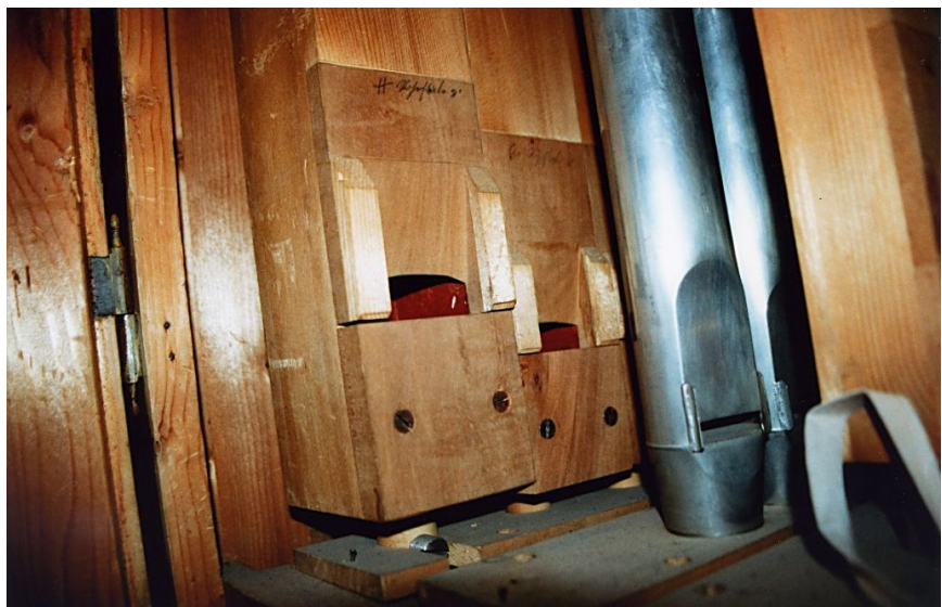
Holz Pfeifen der Rohrflöte 8' mit wohl originaler Beschriftung von Schefold!
