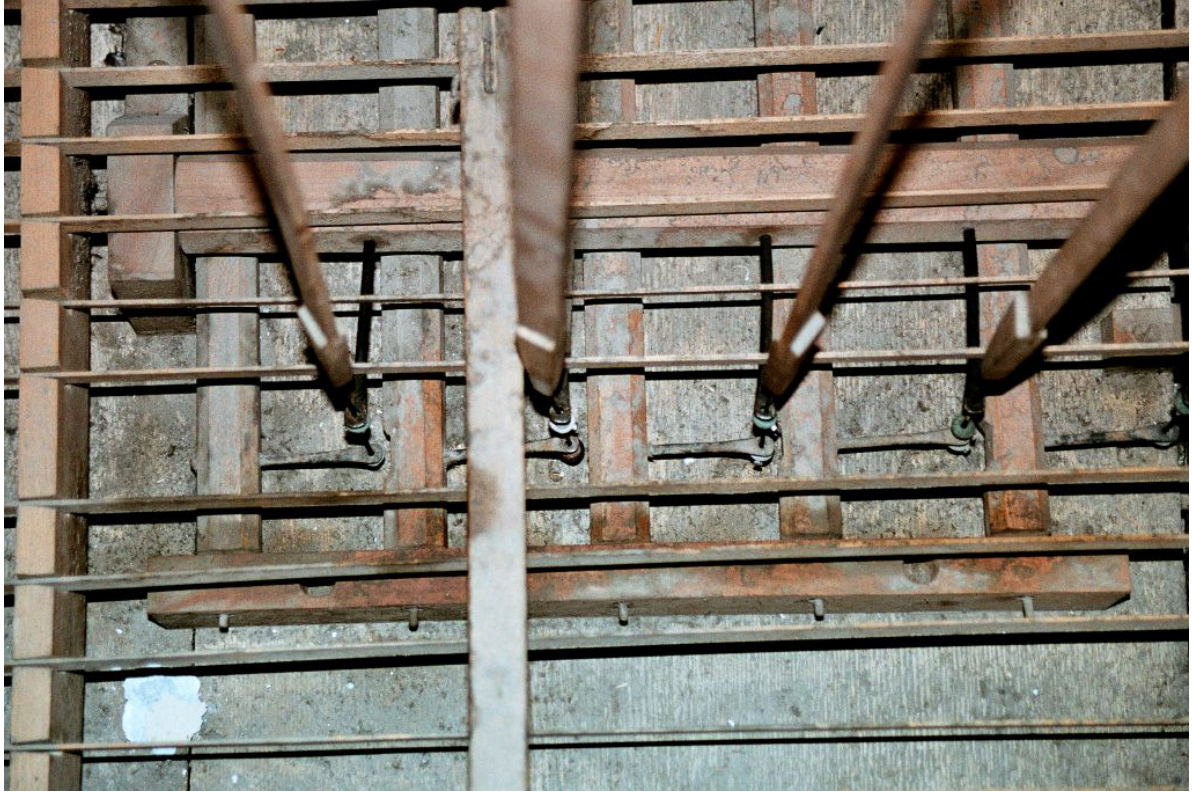
Die Mechanik des Collectivzugs
