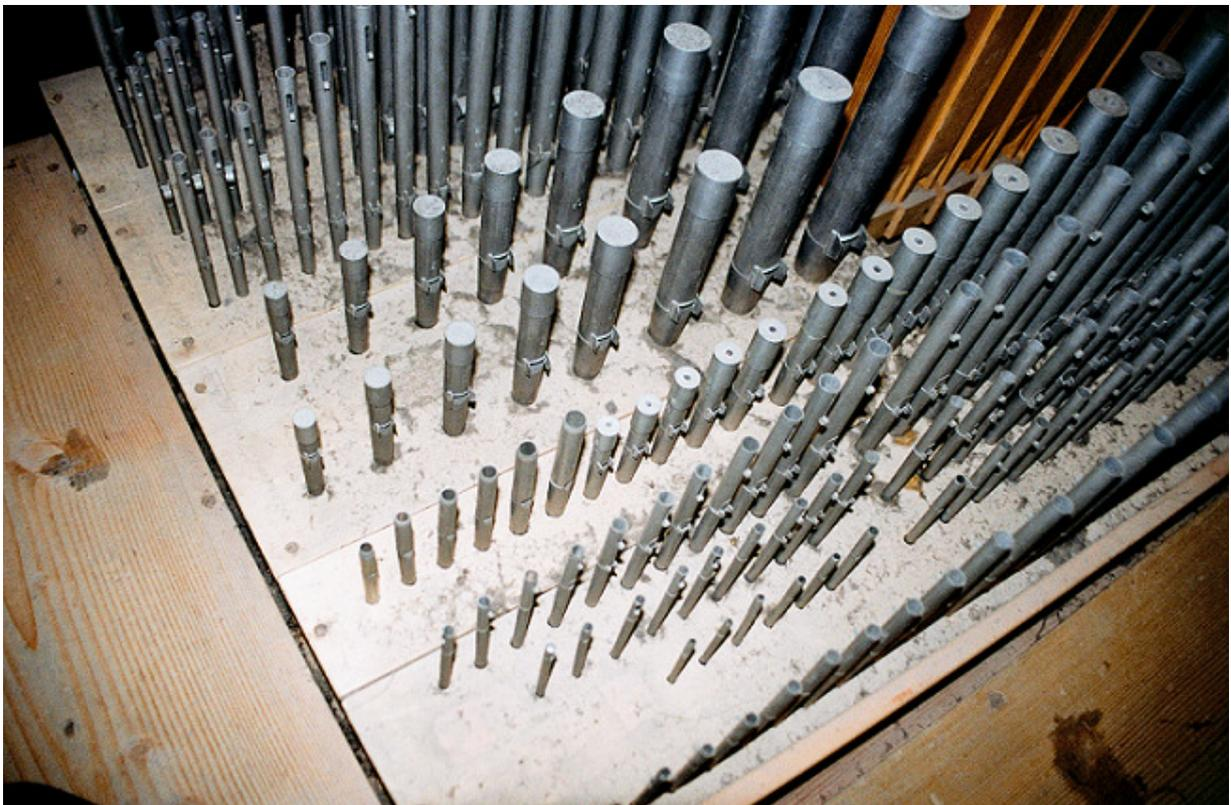
Im Vordergrund die Mixtur, gut zu erkennen sind die sehr aufwändig gearbeiteten Pfeifen
